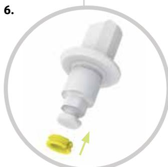
6. Installez la bague de serrage ZERALOCK™ PEEK Spannring.
