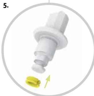
**5.** Installez la bague de serrage ZERALOCK™ PEEK Spanning.
